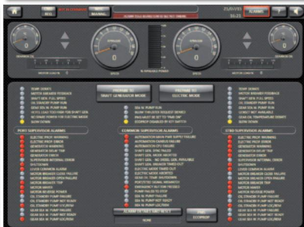
L'elevata flessibilità dell'architettura Onyx Marine Automation permette di interfacciare l'automazione di bordo con qualsiasi dispositivo elettrico o elettronico: questo diventa di importanza cruciale in presenza di un sistema di propulsione ibrida, dove l'automazione di bordo diventa il punto di unione dei sistemi di propulsione tradizionale, di propulsione elettrica e di generazione.
